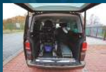
MOBILNÍ NÁJEZDOVÉ LIŽINY (snadné nakládání elektrického vozíku do vozu)
