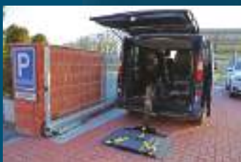
NAKLÁDACÍ ZAŘÍZENÍ ELEKTRICKÉHO VOZÍKU JOEY LIFT (bezproblémová přeprava elektrického vozíku, nebo skútru)
